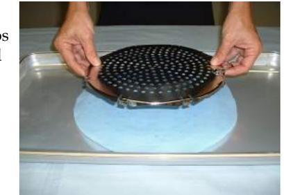
3. Guíe el lateral de la placa opuesto al asa de forma que encaje perfectamente contra la zona elevada del orificio de ventilación.
