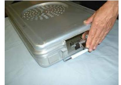
12. Inserte una llave de bloqueo garantizada contra falsificaciones a través de las tres aberturas del pestillo en cada extremo del recipiente. Inserte de izquierda a derecha con el punto del indicador del proceso mirando hacia usted. Asegúrese de que cada llave de bloqueo garantizada contra falsificaciones se introduce completamente tal como se muestra y la flecha se ve totalmente detrás de la segunda apertura.
