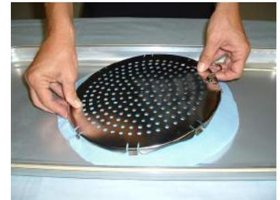
4. Mientras presiona firmemente en el lateral opuesto al asa, presione el asa para asentar la placa del dispositivo de retención.
